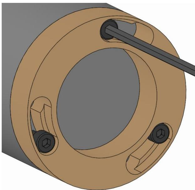
3. Apretar los tornillos de fijación de la pieza intercambiable con el par de apriete estipulado [véase el capítulo «Pares de apriete de tornillos»].
