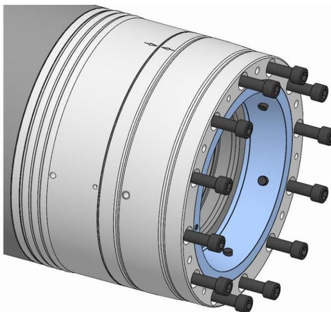
9. Atornillar los tornillos de fijación de la unidad de funcionamiento con el par de apriete estipulado [véase el capítulo «Pares de apriete de tornillos»].
