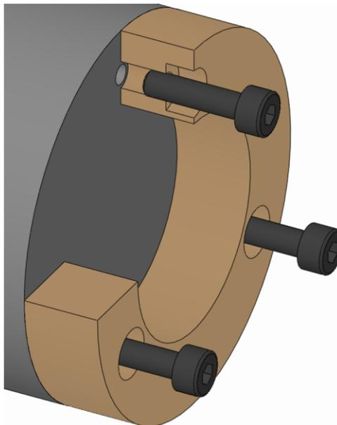
2. Atornillar los tornillos de fijación de la pieza intercambiable con el par de apriete estipulado [véase el capítulo «Pares de apriete de tornillos»].
