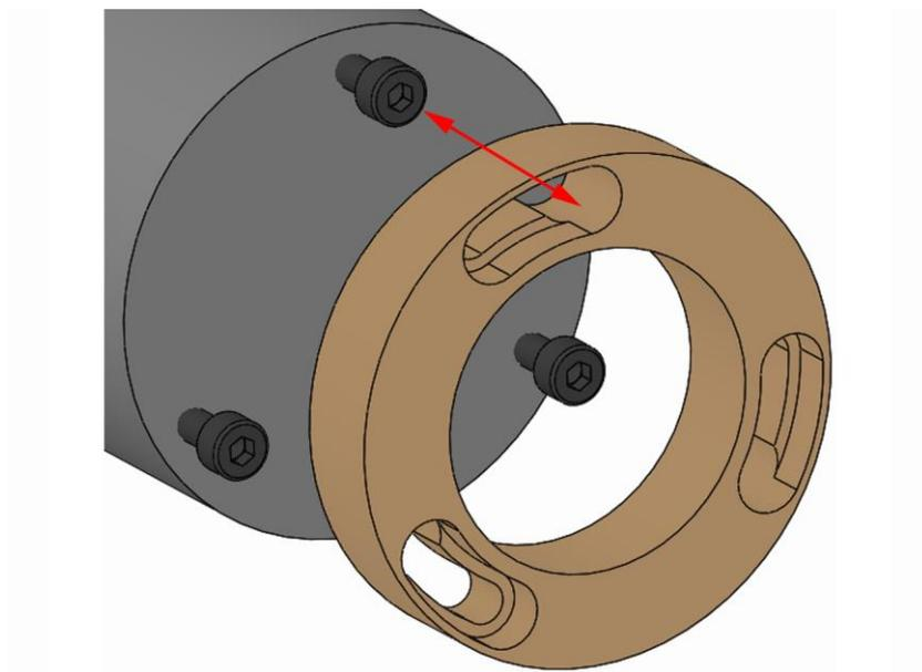
1. Colocar la pieza intercambiable en el producto de forma que la cabeza del tornillo de fijación de la pieza intercambiable encaje a través de la abertura de bayoneta.
