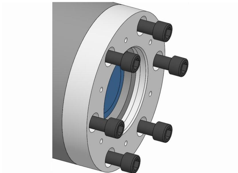
4. Atornillar los tornillos de fijación de la brida del husillo con el par de apriete estipulado [véase el capítulo «Pares de apriete de tornillos»].
