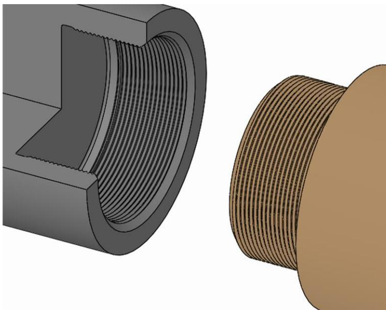
1. Enroscar y apretar la pieza intercambiable mediante su rosca en el producto.
