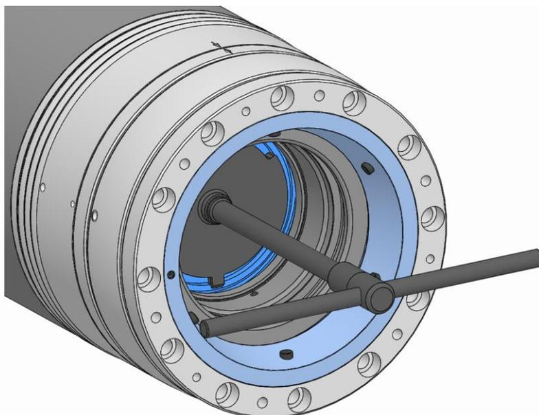
6. Atornillar hasta el tope el adaptador de tubo de tracción de la unidad de funcionamiento con la ayuda de montaje en el tubo de tracción de la máquina.
