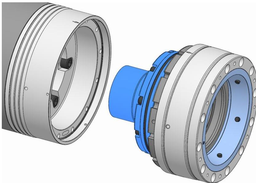
4. Colocar la unidad de funcionamiento en la brida del husillo de tal forma que coincidan las marcas de equilibrado en la brida del husillo y la unidad de funcionamiento.
