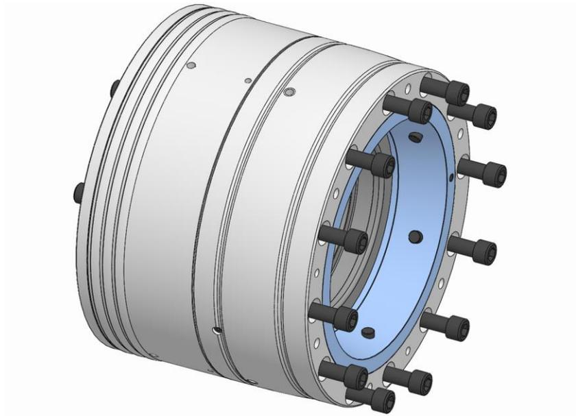
4. Aflojar y retirar los tornillos de fijación de la unidad de funcionamiento.
