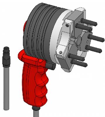
Los pasadores del dispositivo de cambio se introducen en las perforaciones de cambio en el cabezal de sujeción. El dispositivo de cambio se acciona con aire a presión. Dependiendo del tamaño de construcción, el dispositivo de cambio está diseñado para su accionamiento con una o dos manos. El cabezal de sujeción está firmemente sujeto en el dispositivo de cambio y puede colocarse con ayuda del dispositivo de cambio en el dispositivo de sujeción montado.
