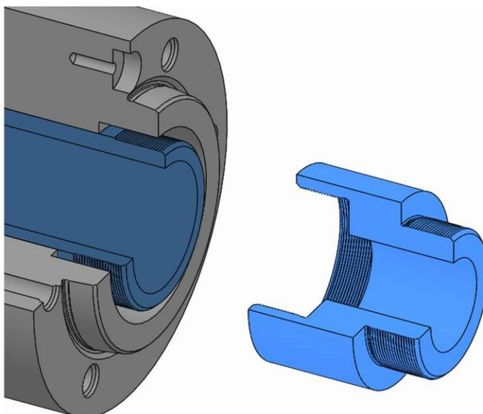
1. Si el adaptador de tubo de tracción se ha montado al tubo de tracción de la máquina, desatornillarlo mediante su rosca del tubo de tracción de la máquina.
