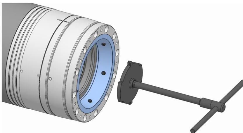
5. Colocar la ayuda de montaje en la unidad de funcionamiento de tal forma que la ayuda de montaje engrane en las ranuras del adaptador del tubo de tracción de la unidad de funcionamiento.
