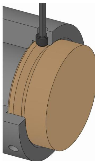
1. Desenroscar la abrazadera de tornillo de la pieza intercambiable hasta que la pieza intercambiable pueda extraerse.
