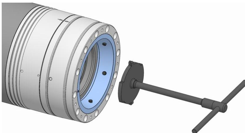
6. Colocar la ayuda de montaje en la unidad de funcionamiento de tal forma que la ayuda de montaje engrane en las ranuras del adaptador del tubo de tracción de la unidad de funcionamiento.
