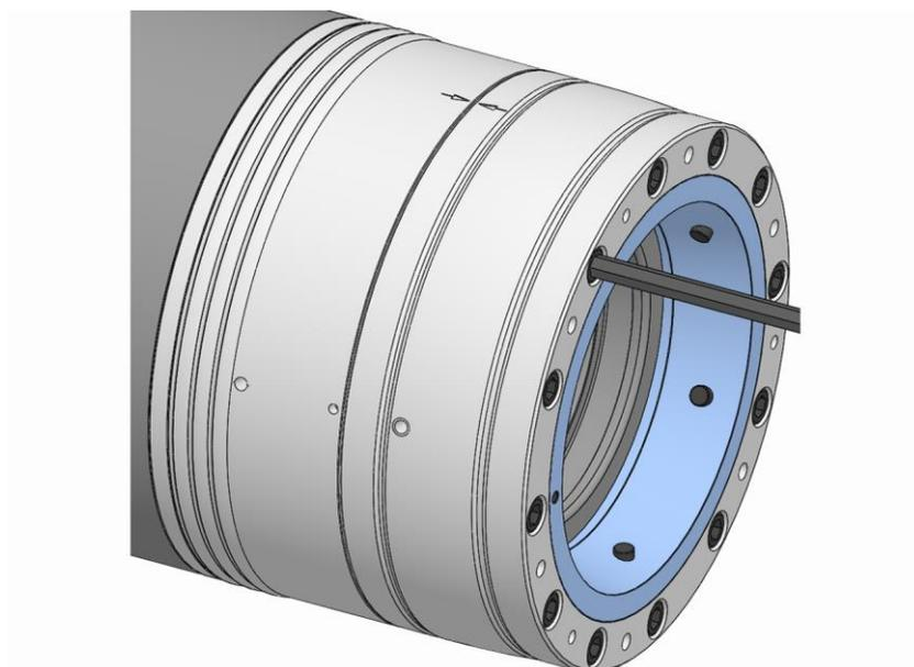
13. Apretar los tornillos de fijación de la unidad de funcionamiento con el par de apriete estipulado [véase el capítulo «Pares de apriete de tornillos»].
