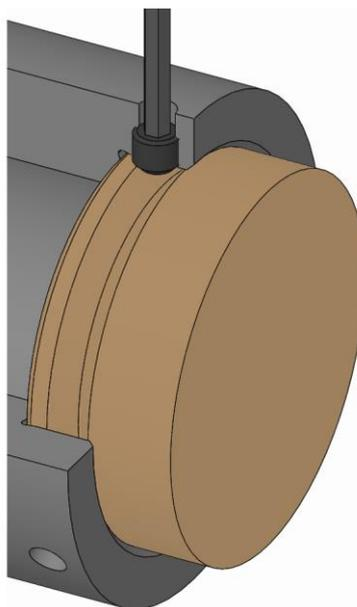
2. Enroscar las abrazaderas de tornillo de la pieza intercambiable y apretar con el par de apriete estipulado [véase el etiquetado].
