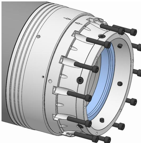
9. Introducir y atornillar ligeramente los tornillos de fijación de la unidad de funcionamiento.
