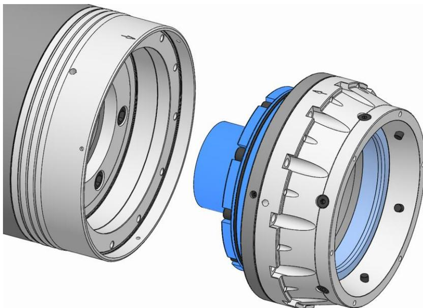
4. Colocar la unidad de funcionamiento en la brida del husillo de tal forma que coincidan las marcas de equilibrio en la brida del husillo y la unidad de funcionamiento.
