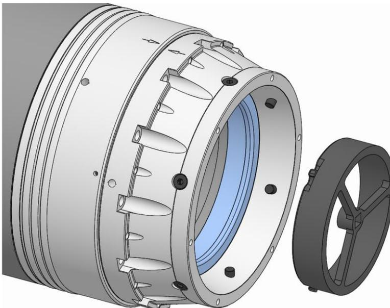
5. Colocar la ayuda de montaje en la unidad de funcionamiento de tal forma que la ayuda de montaje engrane en las ranuras del adaptador del tubo de tracción de la unidad de funcionamiento.
