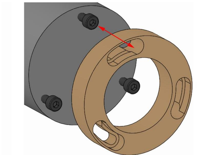
1. Colocar la pieza intercambiable en el producto de forma que la cabeza del tornillo del tornillo de fijación de la
