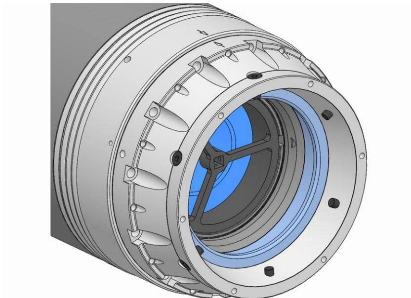
6. Atornillar hasta el tope el adaptador de tubo de tracción de la unidad de funcionamiento con la ayuda de montaje en el tubo de tracción de la máquina.
