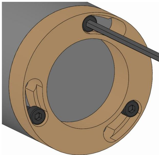
3. Apretar los tornillos de fijación de la pieza intercambiable con el par de apriete estipulado [véase el capítulo «Pares de apriete de tornillos»].
