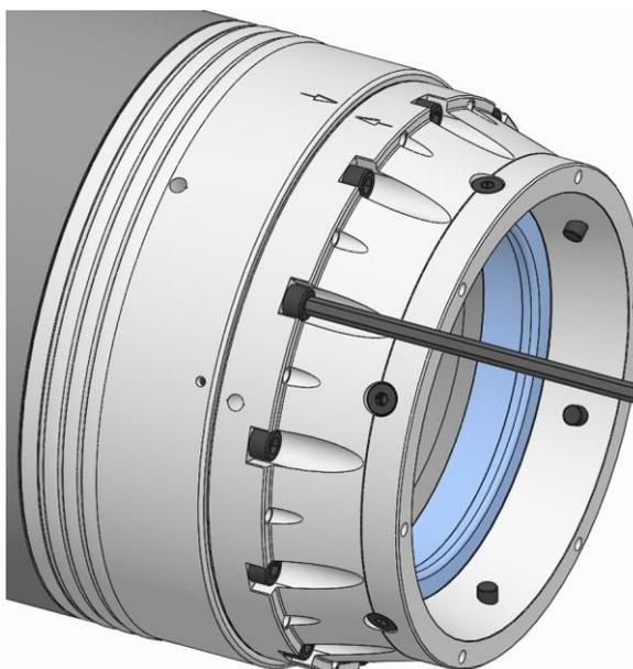
13. Apretar los tornillos de fijación de la unidad de funcionamiento con el par de apriete estipulado [véase el capítulo «Pares de apriete de tornillos»].
