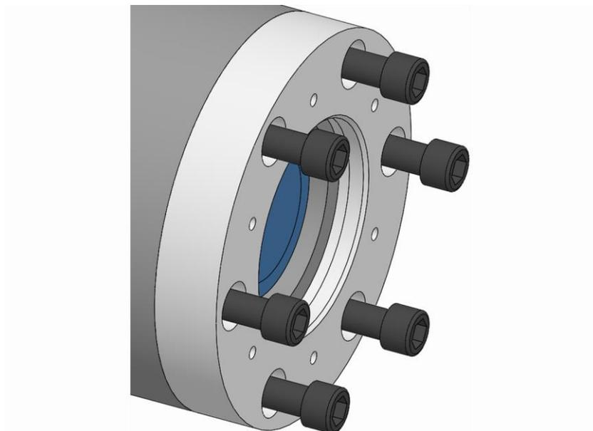
3. Aflojar y retirar los tornillos de fijación de la brida del husillo.
