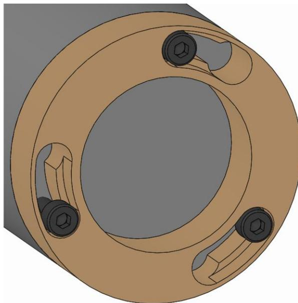
2. Girar la pieza intercambiable de forma que la cabeza del tornillo de fijación de la pieza intercambiable encaje a través de la abertura de bayoneta.
