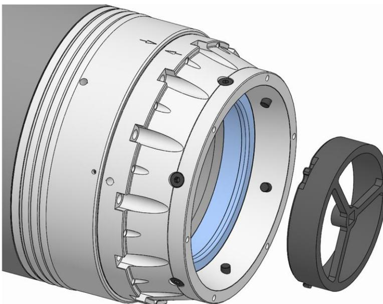
6. Colocar la ayuda de montaje en la unidad de funcionamiento de tal forma que la ayuda de montaje engrane en las ranuras del adaptador del tubo de tracción de la unidad de funcionamiento.
