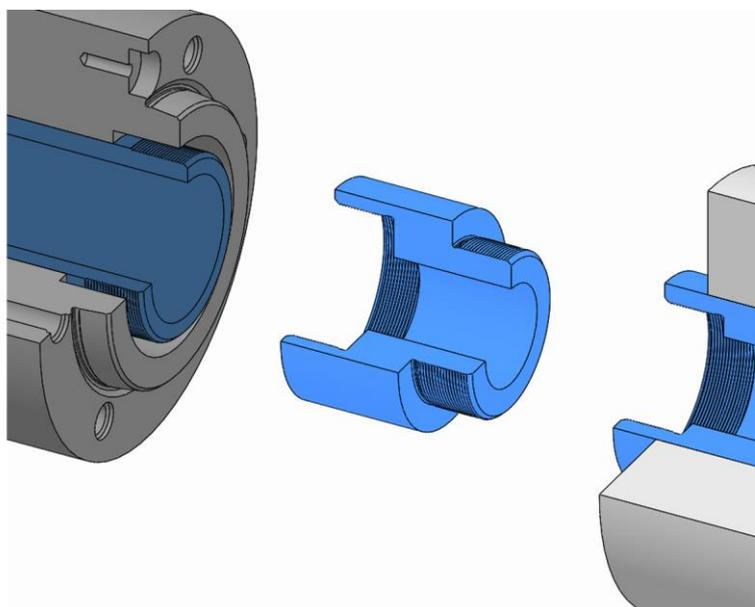
1. Enroscar el adaptador de tubo de tracción mediante su rosca en la unidad de funcionamiento o enroscarlo y apretarlo en el tubo de tracción de la máquina.
