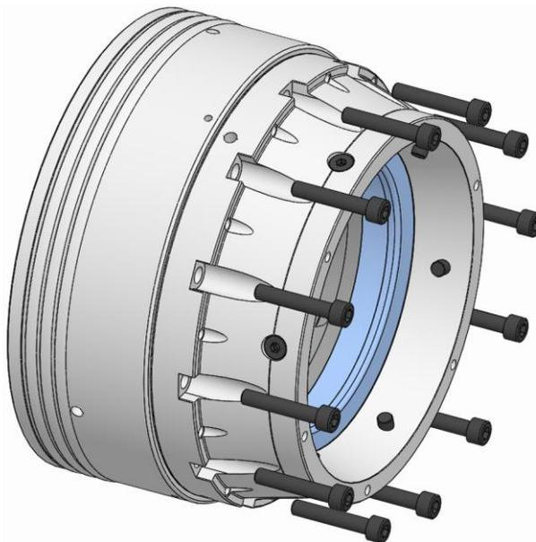
4. Aflojar y retirar los tornillos de fijación de la unidad de funcionamiento.
